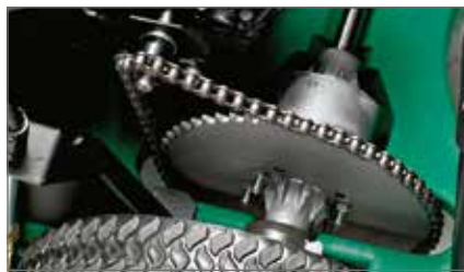
3-rychlostní převodovka Modely MV s vlastním pojezdem jsou vybaveny plynulým převodem se třemi stupni.
